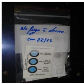
Pequeno ziploc, com papel de filtro impregnado e colocado entre papéis cristais, carta indicadora de humidade e dessecador
