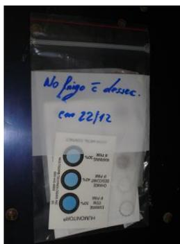
Pequeno ziploc, com papel de filtro impregnado e colocado entre papéis cristais, carta indicadora de humidade e dessecador
